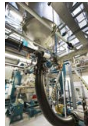
De onderzijde van de Pearl reactor waar het struviet wordt gevormd
