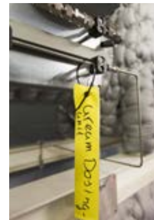
De onderzijde van de Pearl reactor waar het struviet wordt gevormd
